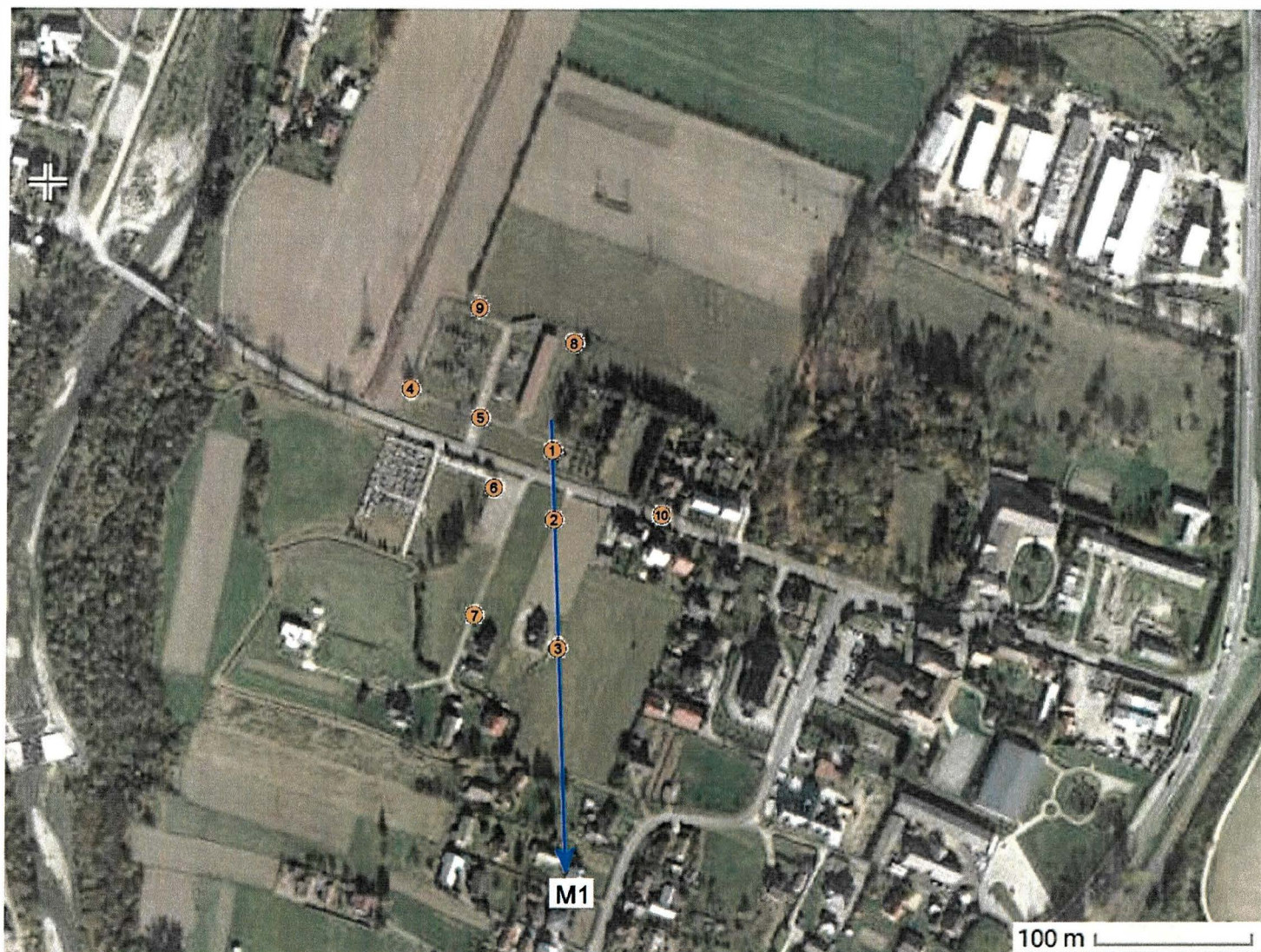
ZaŃ. nr 2: Lokalizacja anten oraz ich azymuty, lokalizacja pionów (punktów pomiarowych wokół instalacji radiokomunikacyjnej). -punkt (pion) pomiarowy.
